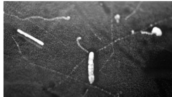
Auch auf die Ladung der Teilchen kann geschlossen werden. Dafür legt man ein Magnetfeld durch die Kammer, das die elektrisch geladenen Teilchen auf Grund der Lorentzkraft ablenkt. Mittels der Richtung und Stärke der Ablenkung lässt sich dann die Ladung bestimmen. Wird ein Teilchen wiederum nicht abgelenkt, so muss es elektrisch neutral sein.
